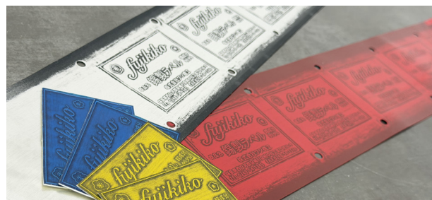
④糊付け・カットを行い、完成です。剥離紙を剥がせば瓶へ装着できます。
